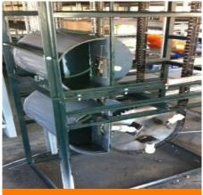
Seccion de dos contenedores con sistema de válvulas automáticas para inflado de recipiente en la zona inferior.
